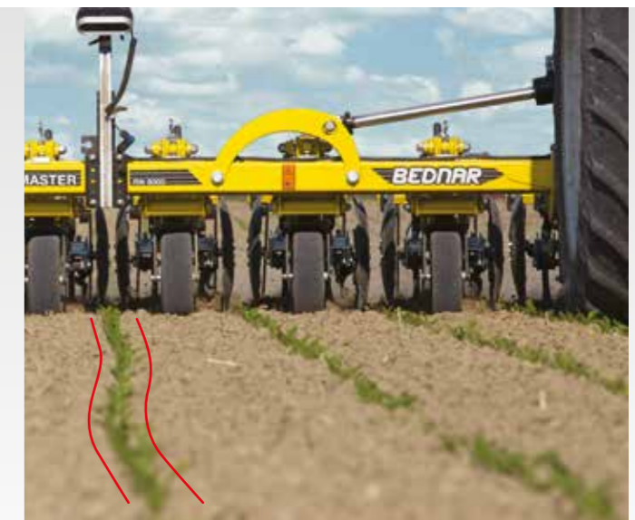
Samonaváděcí systém je schopný vést Row-Master i v případě, že plodiny jsou vysety do oblouku.
