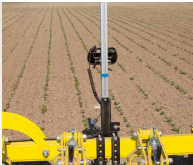
Výšku a úhel natočení kamery je možné nastavit podle aktuálního stádia růstu porostu.
