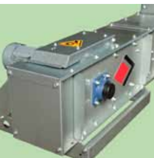
Klapka pri preplnení/kontrolný otvor s bezpečnostným vypínačom.
