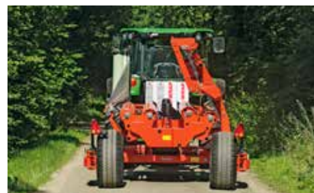
Před jízdou po silnici se kola mohou stočit dovnitř, aby se zmenšila přepravní šířka. K dispozici je i volitelná funkce hydraulického stáčení
