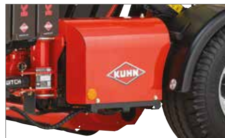
Velký boční kryt chrání hydraulickou jednotku umožňují snadný přístup při údržbě stroje
