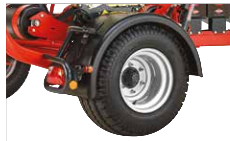
Velké blatníky zabraňují poškození fólie během přepravy
