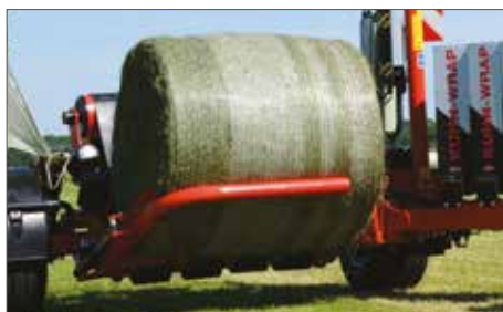
Dlouhé nakládací rameno zaručuje rychlé a šetrné nakládání balíku
