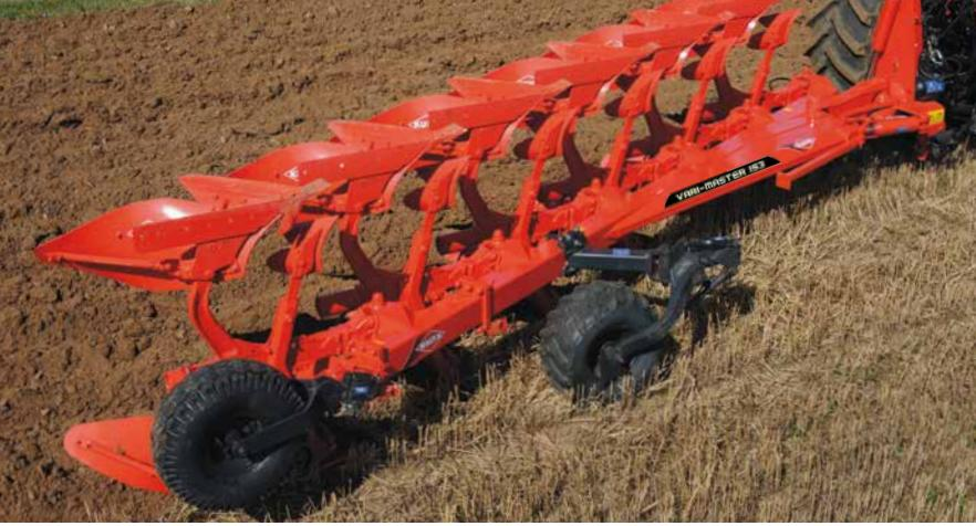
Kolo je vybaveno centrálním otočným čepem, který umožňuje automaticky kopírovat všechny změny pracovního záběru. Hloubka se nastavuje šroubem **1** nebo hydraulicky **2**, přičemž na každé straně může být nastavení odlišné. Kolo pro hloubkové nastavení lze montovat v mnoha různých polohách na rámu a tím je zajištěno optimální využití.
