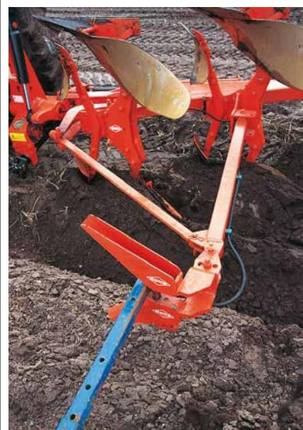
Rameno je k dispozici pro všechny řady pluhů. Umožňuje agregovat pluh s půdními pěchy s hydraulickým systémem připojení. Veškerá mazací místa jsou chráněna pro poškození vhodným umístěním na rámu. Při dopravě je rameno vyklopeno směrem vzhůru.
