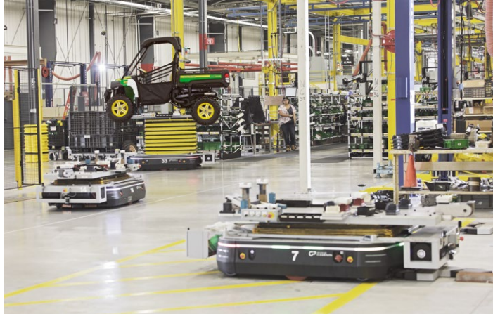
Mobilný robot s názvom OTTO si dobíja batérie v dokovacej stanici. Roboty OTTO neustále rozvážajú súčiastky naprieč montážnou linkou a udržiavajú tak plynulosť výroby.
