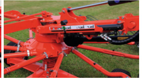
GA 7501 +, hydraulické nastavení
