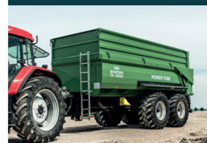
TA 22053/2 XPT+ vyrobená výhradně z ocelového plechu o tloušťce 6 mm, výška 1000 mm
