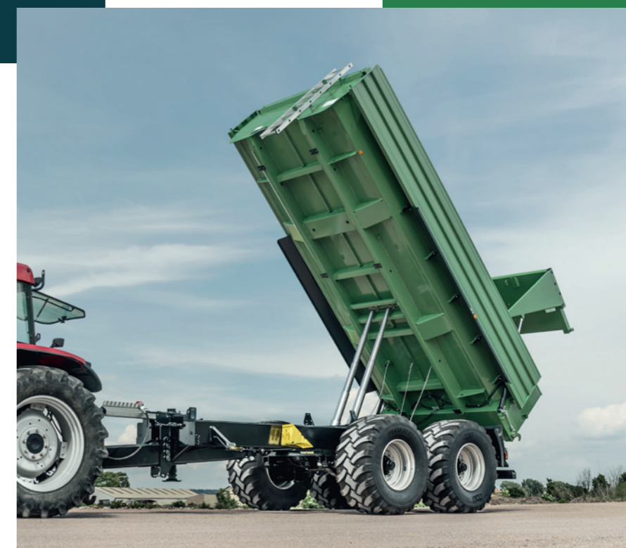
TA 22065/2 XPT+ silné nápravy s 32 t odpružením, přírubové tažné zařízení K 80 pro 4t svislé zátěže podpěry
