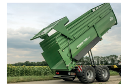
TA 24080/2 PT+ délka vany 8000 mm, sériově se vzduchovým odpružením a automatickým sklápěním
