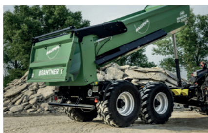
Hydraulická kyvadlová klapka dvojčinné hydraulické otevírání zadní stěny s dvojí funkcí
