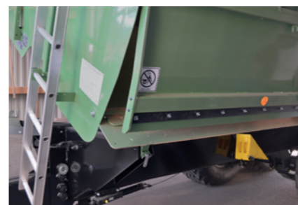
Skluz pro opatrné vykládání pomocí bočně sklopného skluzu
