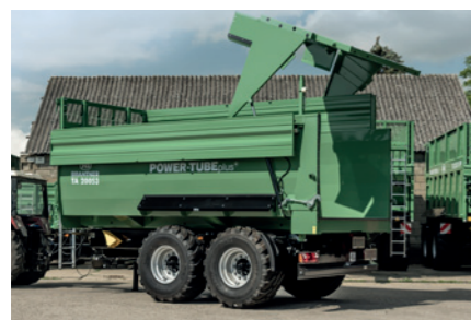
sklopné nástavné stěny, zadní čelo lze hydraulicky otevřít, když jsou nástavné stěny sklopené
