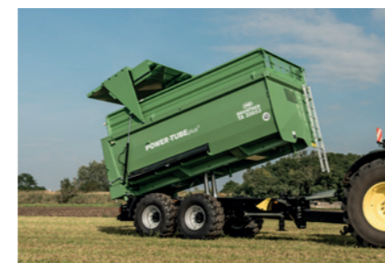
TA 20053/2 PT+ s kónickou vanou, vyrobenou výhradně z ocelového plechu o tloušťce 4 mm
