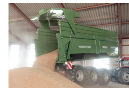
TR 34080/2 PT+ 34 t celková hmotnost, na přání s hydraulicko-mechanickým nuceným řízením
