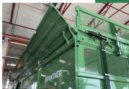
hydraulicky sklopný nástavek volitelně pravá či levá strana
