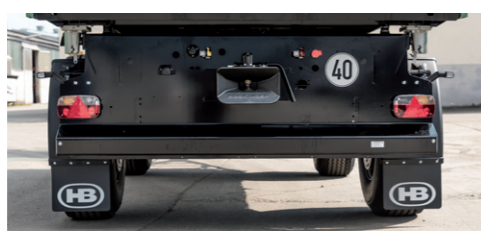
Vícebodové osvětlení s gumovými lapači na blatnících
