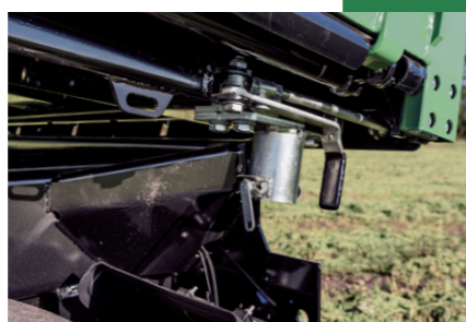
Sklopná ložiska uložena daleko ven pro ještě větší stabilitu
