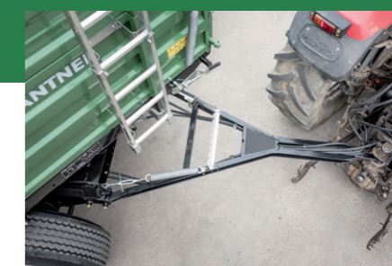
Oj Oj Y pro extrémně malé poloměry otáčení
