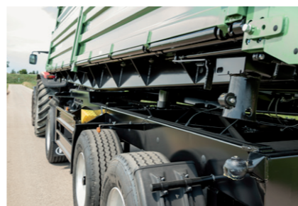
Rám s příčnými výztuhami (ze sektoru nákladních vozů) s široce uloženými sklápěcími závěsy
