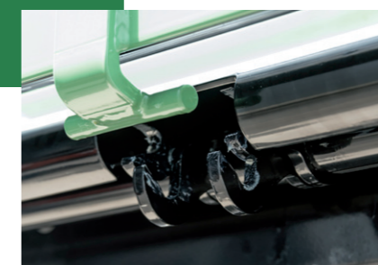
Sklopné panty od délky plošiny 5 m s dvojitým zamykáním
