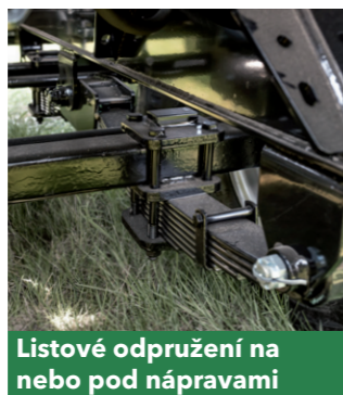
Parabolické odpružení na nápravách
