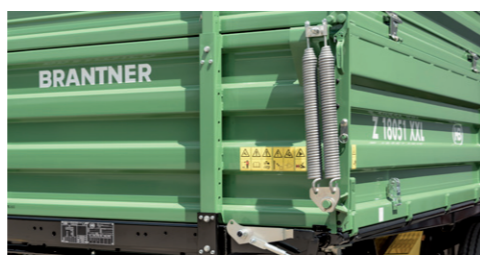
Dvě zvedací pružiny. Pro dvojitou boční stěnu, uložena jako otočná
