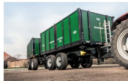
Inovace fy Brantner- model TA 20051/2 XXL lze volitelně konfigurovat jako multiplex nebo stabilátor
