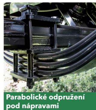
Parabolické odpružení na nápravách
