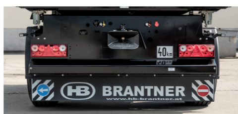
Osvětlení Euro-point II s gumovými lapači po celé šířce nárazníku
