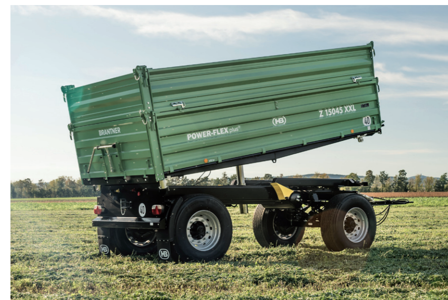
Z 15045 XXL SPECIÁLNÍ NABÍDKA Volitelně: PROFI paket se 2 vyklápečími válci, zesílením bočních stěn, zvedacími pružinami bočních stěn a podlahou z ocelového plechu 5 mm
