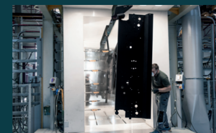
Automatické práškové lakování
