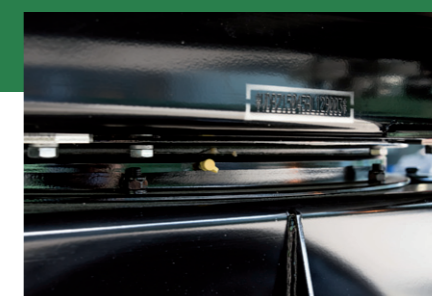
Točna s kuličkovým ložiskem z vlastní výroby
