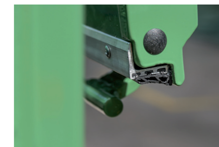
Těsnící profil s protihoty v patentované hliníkové liště
