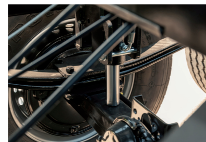
Hydraulická podpora zadní nápravy jako standard pro optimální komfort odpružení
