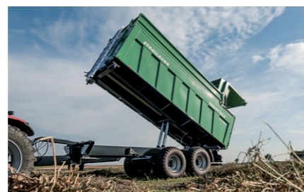
hydraulická zadní stěna volitelně s hydraulicky ovládanou zadní stěnou
