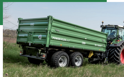
TA 10041 nabízí nejuniverzálnější vybavení, např. s dobytčími schody, hydraulickou zadní stěnou nebo odolnou šterkovou stěnou
