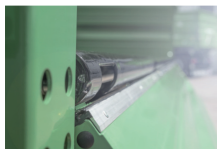
Samočistící hrana podlahy hraněná na všech čtyřech stranách
