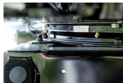
Točna s kuličkovými ložisky Robustní točna s kuličkovými ložisky ze sektoru nákladních vozidel
