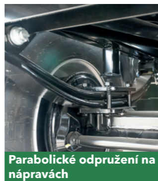
Parabolické odpružení pod nápravami
