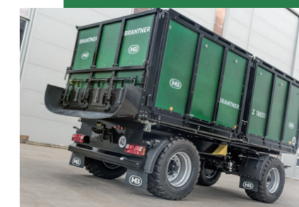
Skluz pro optimální vykládání citlivého volně loženého zboží (např. brambor)
