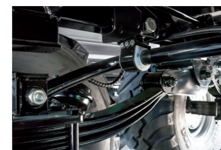
Pružinový stabilizátor dostupný jako volitelná výbava, doporučený pro řízené nápravy
