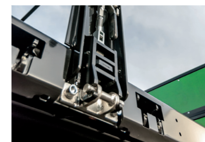
středový sloupek, který lze odstranit bez použití nářadí (volitelné), může být užitečný při nakládání beden nebo palet
