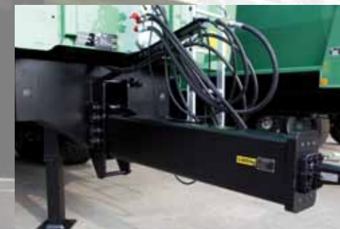
Spodní závěs tažná oje ze zdvojeného C-profilu
