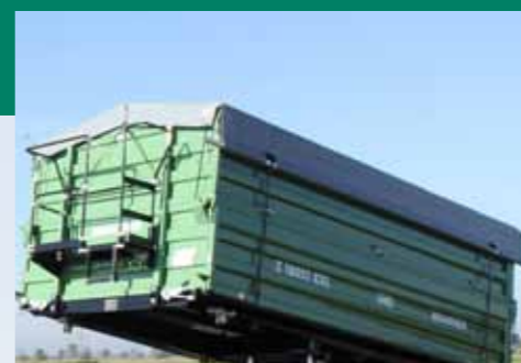
Plachta s trojúhelníkovými nástavky a s obslužnou plošinou
