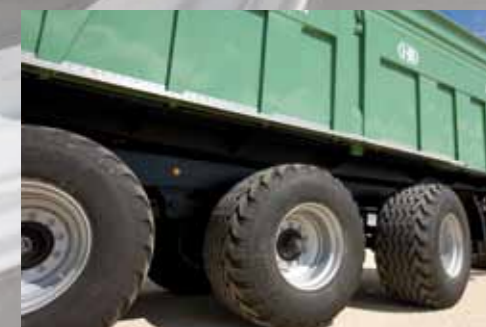
Řiditelná náprava zvyšuje obratnost a snižuje opotřebení pneumatik
