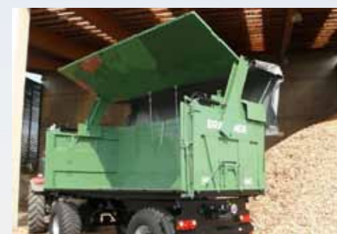
Hydraulická bočnice typu Stabilátor s otevíráním do vrchu
