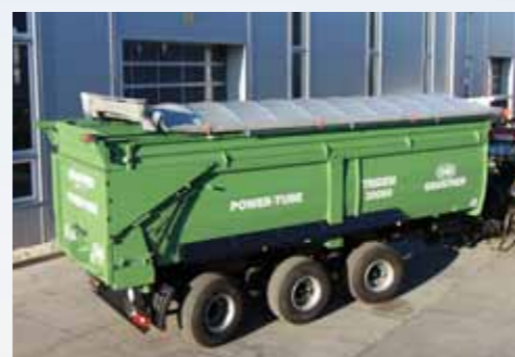
Výsuvná plachta elektricky
