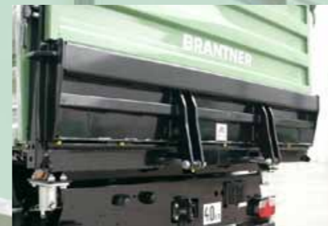
Hydraulická zadní stěna 120° s lisovaného profilu
