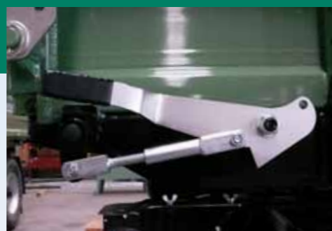
Výklopné bočnice páka centrálního uzavírání
