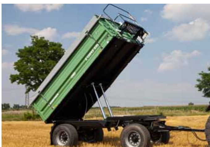
Z 13045/2 XXL se dvěma válci pro optimální stabilitu při klopení, s rolovací plachtou
