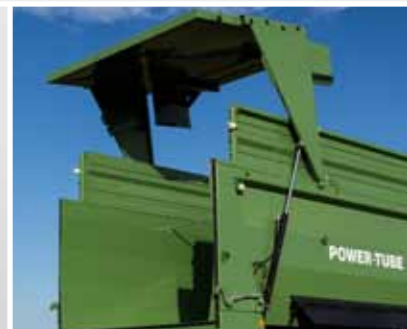
hydraulické, dvojitě uzavírání zadního čela
