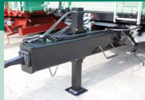
Hydraulická opěrná noha dvojitá, vedení trubka v trubce
