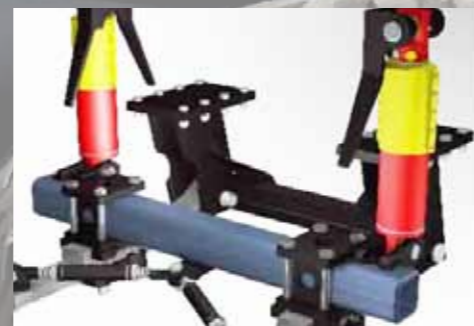
Hydraulický podvozek hydraulicky odpružená náprava
