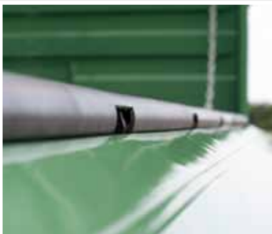
Patentované ukončení samočisticí ložné plochy
