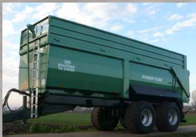
TA 24080/2 Power Tube délka korby 8.000 mm (řízená náprava a rozchod 2.250 mm sériově)
