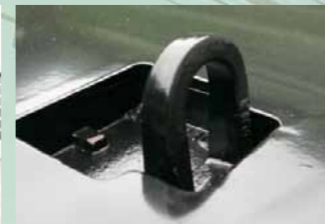
Kotvicí oka EN 12640 zapuštěné v ložné ploše
