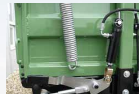
Hydraulické otevírání výklopných bočnic pro pravou a levou stranu (předělavatelné)
