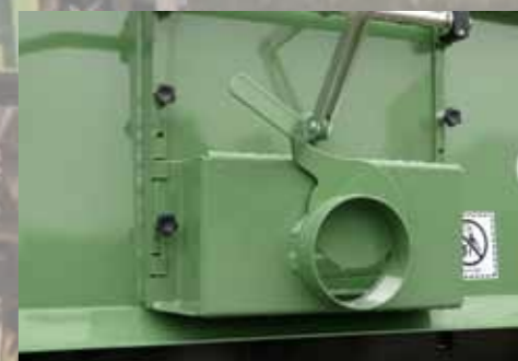
Usměrňovací trubka na šoupátku s jemným dávkováním
