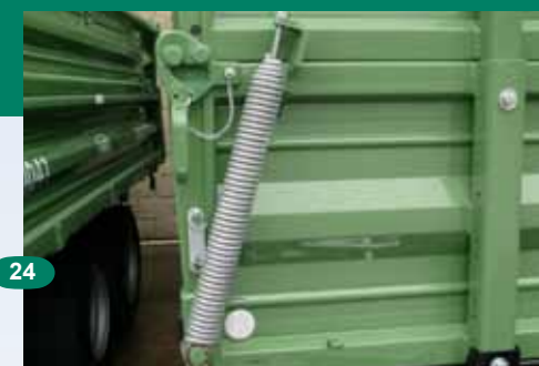
Pomocné pružiny na zvedání bočnic jeden kus na pravé a levé straně
