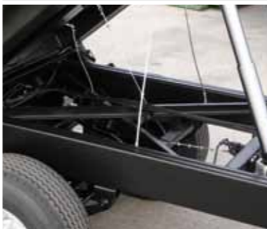
Křížové vyztužení nosného rámu
