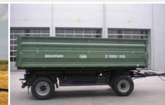
Z 15051/2 XXL s boční ochranou proti podjetí a s vyztužením bočnic
