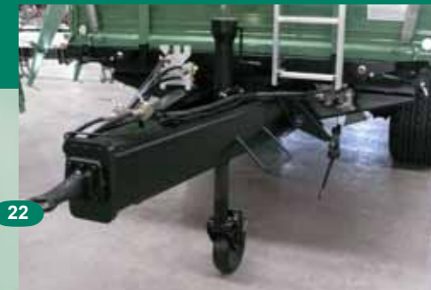
Opěrná noha s kolem opěrná noha výškově stavitelná s kolem
