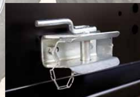
Zadní mechanický závěs nad 25 km/h a 8 t celkové hmotnosti
