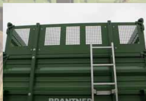
Průhledové síto přes celou šířku
