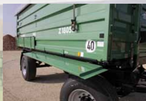
Stabilní boční skluz uzavíratelný v jednom s výklopnými bočnicemi
