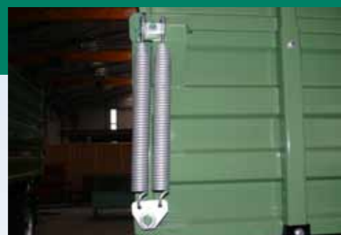
Pomocné pružiny na zvedání bočnic dva kusy na pravé a levé straně (možné pouze u spodní bočnice 800 mm)
