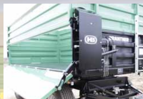
Hydraulická bočnice bočně otevíratelná a uzavíratelná o 180°
