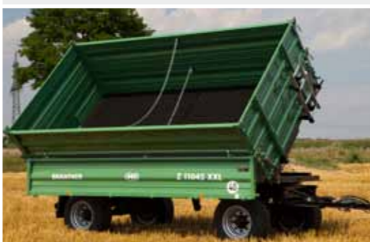
Z 11045 XXL výklopná bočnice na pravé a levé straně sériově
