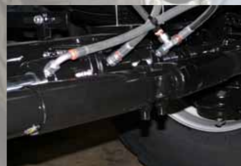
Vlečně řízená náprava nutné uzamykání při zpětné jízdě a na silnici
