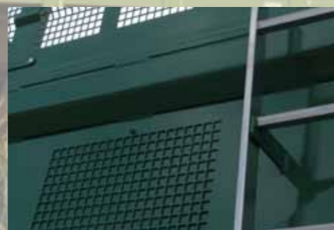
Průhledové síto s plechovým krytem
