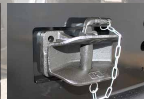
Zadní mechanický závěs nad 25 km/h a 15t celkové hmotnosti
