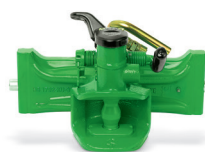
Automatický a mechanický záves s čapom 38 mm
