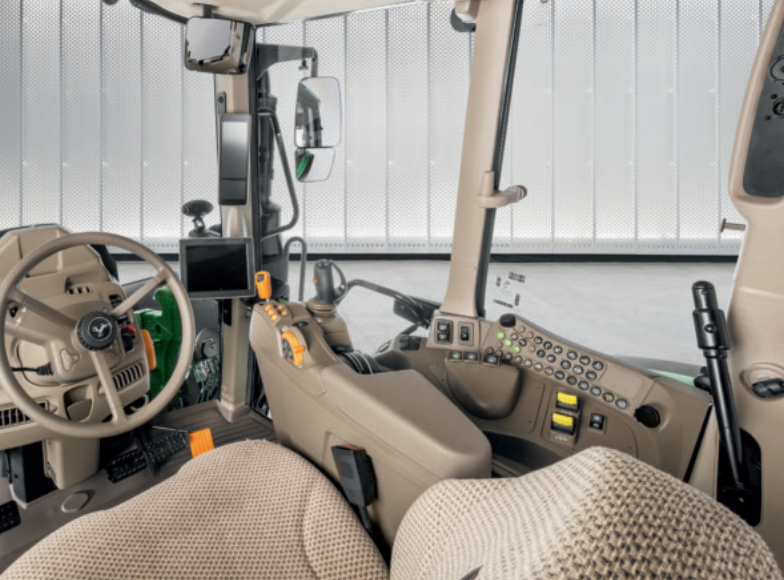
Intuitívne rozhranie 6M: Displej v rohovom A-stĺpiku a nová kompaktná CommandARM.
