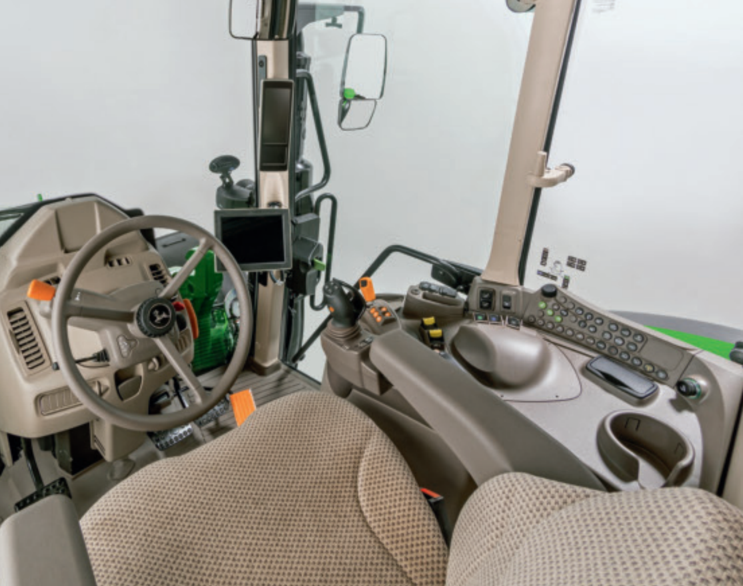
Presné intuitívne, zjednodušené ovládanie funkcií traktora: Displej v rohovom A-stĺpiku a pravá konzola.
