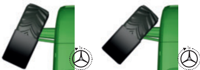
Riadenie s variabilným pomerom vypnuté
