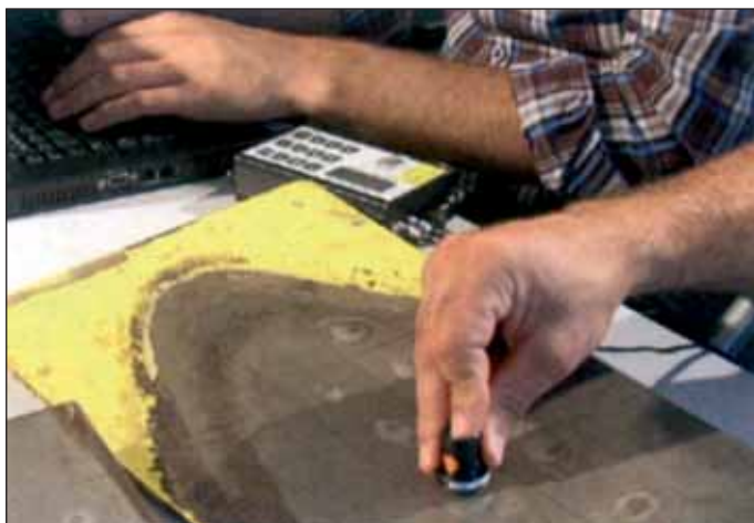
Echometrom sa merala zostatková vrstva materiálu DuraLine.
