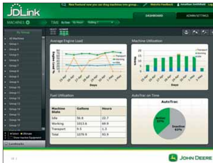
JDLINK vyhodnotí aj percento času využívania navádzania AutoTrac (vpravo dole). Navoliť si môžete aj formu zobrazenia typu práce.
