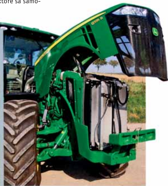
Šetrný aj bez AdBlue: 9 l PSX motor s filtrom pevných častíc.
