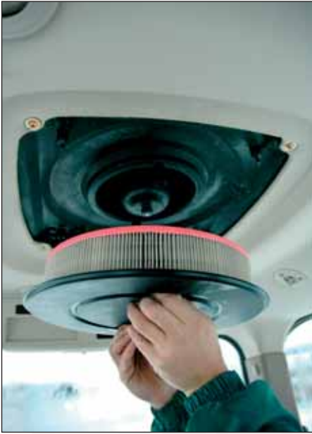
Vonkajší a vnútorný kabínový filter sa jednoducho vyťahuje. Pretlak v kabíne zabezpečuje čistotu.
