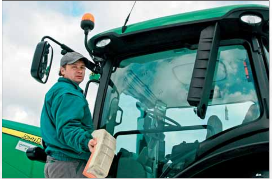
Vonkajší a vnútorný kabínový filter sa jednoducho vyťahuje. Pretlak v kabíne zabezpečuje čistotu.
