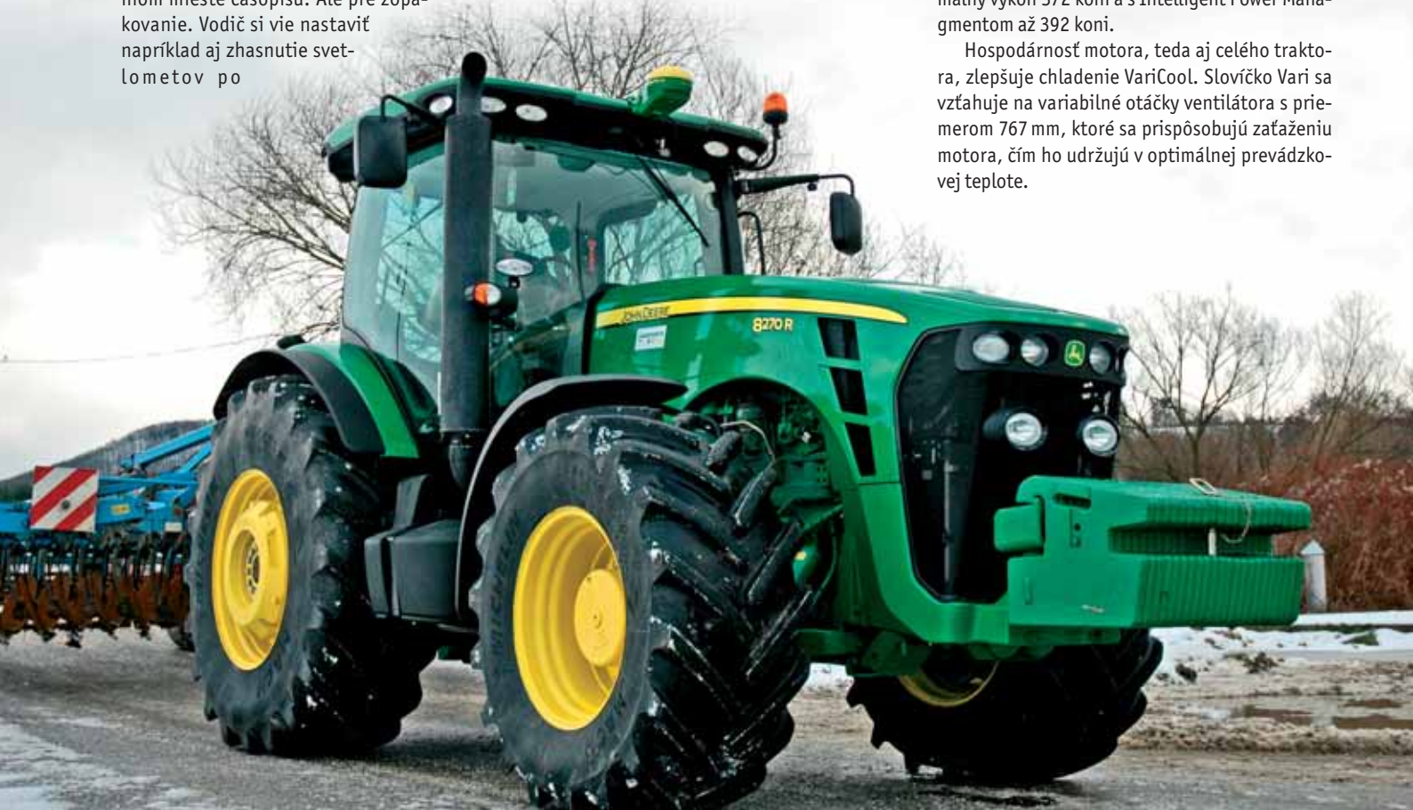
John Deere 8270 R disponuje maximálnym výkonom 312 k. Pod jeho kapotou si hrdie 9,0 l motor JD PowerTech Plus.
