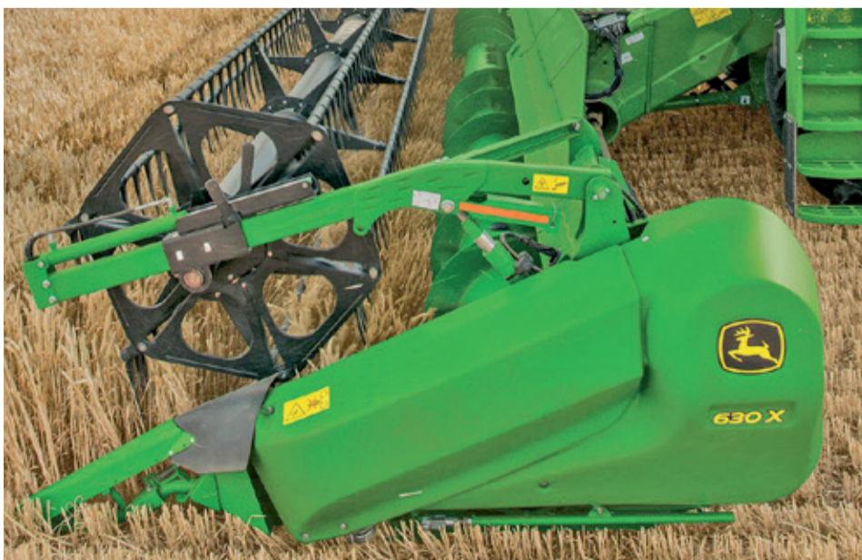
Žací adaptér John Deere 630 X značne uľahčuje prechod zo zberu obilnín na zber repky. Inštalácia bočných kôš a nastavenie adaptéra zaberie podľa skúseností mechanizátora maximálne 10 minút.
