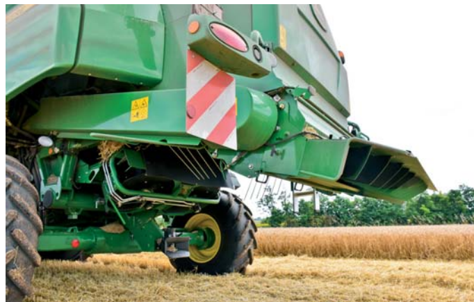
Drvič slamy si vyberáte v 52 a 96 nožovom variante. Hnacia môže byť aj zadná náprava.
