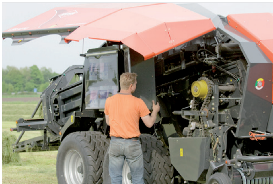
Lisy KUHN LSB 1270 a 1290 disponujú zásobníkom na 24 balíkov špagátu a šiestimi viazacími ústrojenstvami. Zákazníci si pochvaľujú i jeho takmer bezúdržbovú prevádzku.
