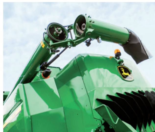
Vyprázdňovacia závitovka kombajnu T670 je umiestnená vo veľkej výške, čo napomáha pri vyprázdňovaní do vysokých vozov. Navyše je možné zložiť ju do prepravnej polohy – nič netrčí za kombajn.
