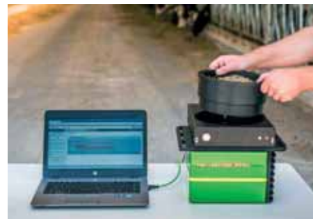
Mobilný HarvestLab 3000 na meranie základných živín viete okrem rezačky použiť aj pri rozbere siláže a pri hnojení hnojivicou.
