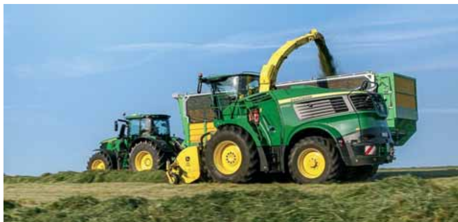
Na riadkoch nezávislé adaptéry Kemper sa vyrábajú v šiestich veľkostiach.
