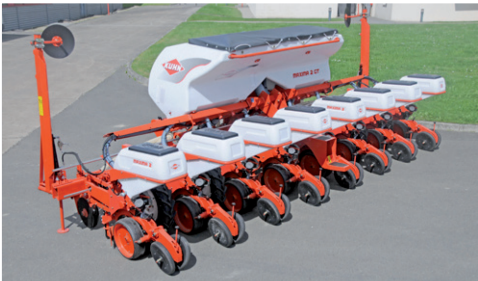
Rad sejačiek MAXIMA 2 je k dispozícii v rôznych prevedeniach. Na obrázku nájdete sejačku s jednoduchým rámom, ktorej prepravná šírka sa rovná pracovnému záberu stroja.
