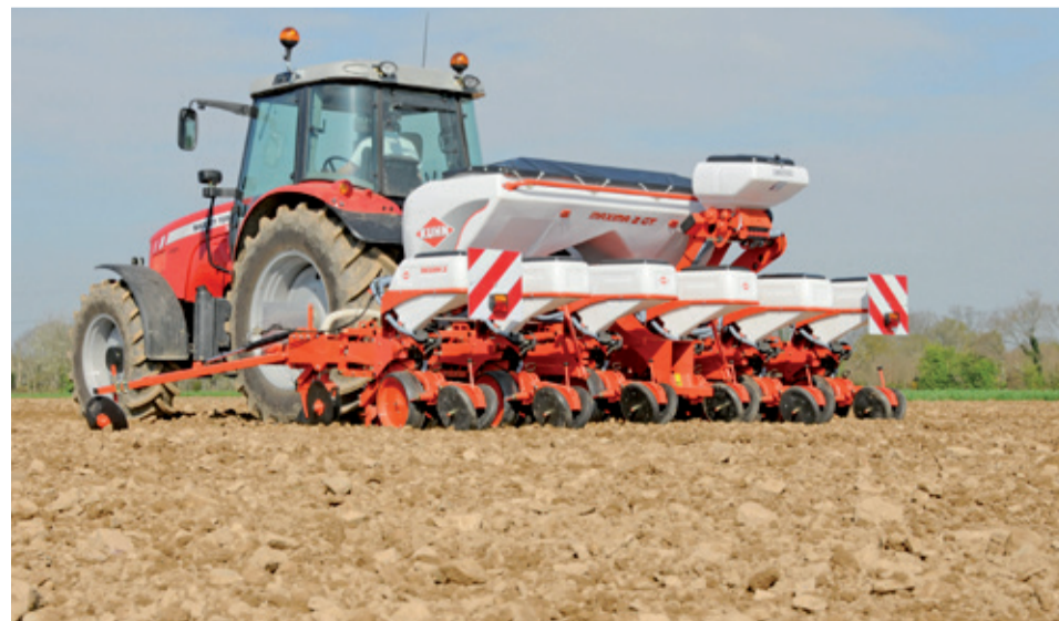
KUHN MAXIMA 2 s dvojitým teleskopickým rámom vďaka svojej konštrukcii spĺňa maximálnu transportnú šírku 3 m.
