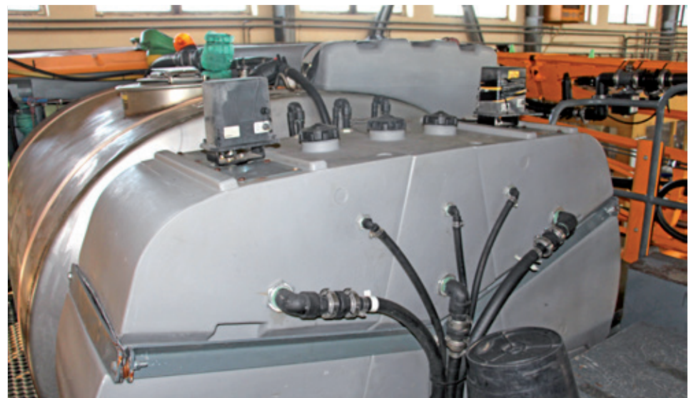
Jedna veľká nádrž s objemom 4 400 l je doplnená o tri menšie nádrže, do ktorých je možné umiestniť viacero prípravkov. Postrekovač si pri aplikácii sám namieša kvapalinu s požadovanou dávkou.
